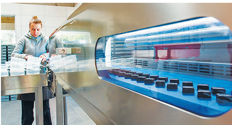
Dank eines 8 m langen Kältetunnels gelangen Produkte von der Überzugsmaschine direkt in die Verpackung. Ein zweiter Tunnel wird bald installiert.
