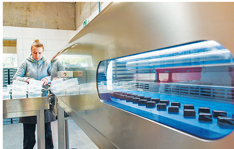
Les chocolats passent directement de l'enrobage à l'emballage, grâce à un tunnel de froid de 8 m de long. Un deuxième sera prochainement installé.
